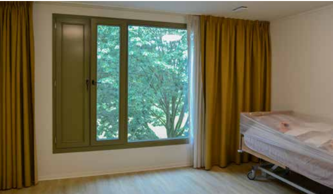
Met zomernachtventilatieluiken worden de zorgappartementen 's nachts op natuurlijke wijze gekoeld, wat bijdraagt aan comfort, gezondheid en energie-efficiëntie.
